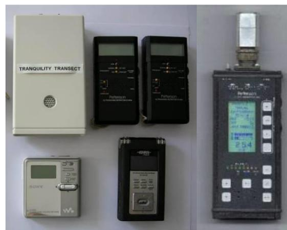
Figure 1 : Détecteurs et enregistreurs utilisés pour les écoutes chiroptères
